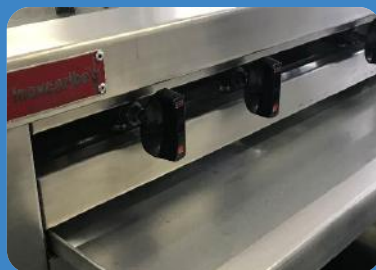
Bandeja recolectora de desperdicios. Botones en función de aluminio.
