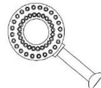
QUEMADOR DE ALTA EFICIENCIA (X6)
