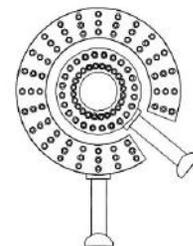
QUEMADOR DE ALTA EFICIENCIA (X1)
